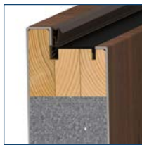
Wypełnienie izolacyjne ekspandowany polistyren modyfikowany grafitem
